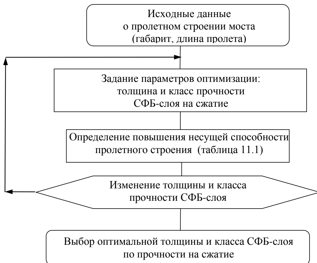
Рисунок 11.1 - Блок-схема метода определения оптимальных параметров СФБ-слоя.
